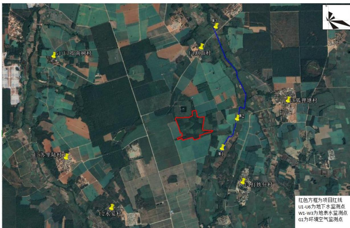
图4.3-1 大气、地表水、地下水监测点位图
