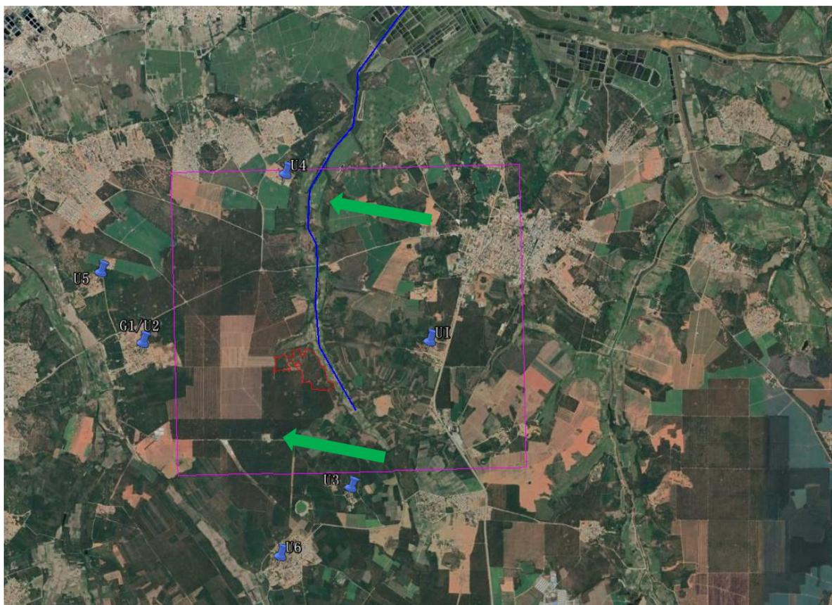
图 4.3-1 区域地下水水位图（箭头为地下水流向）
