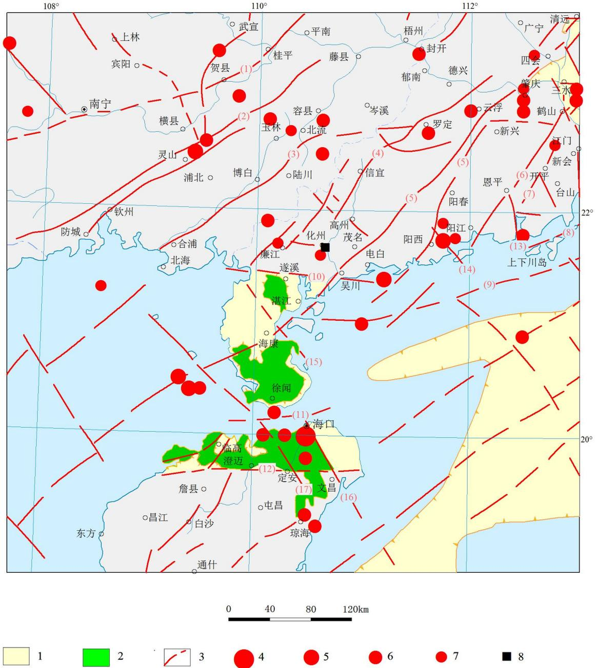
图 5.7-1 区域主要断裂构造与地震分布图
