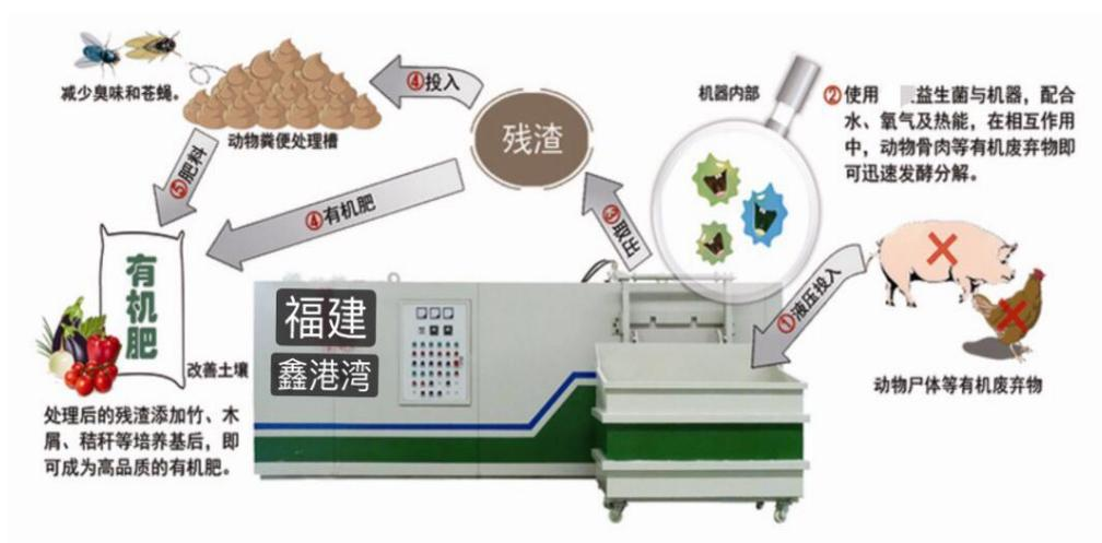
图 3.7-1 病死猪处理工艺流程图
