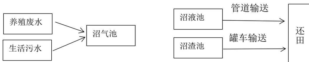
图 7.1-1 污水处理工艺流程图
