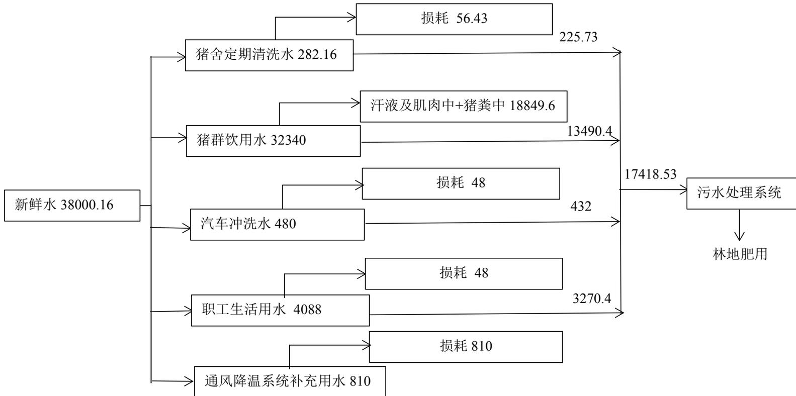
图 3.10-1 本项目水平衡图 (t/a)
