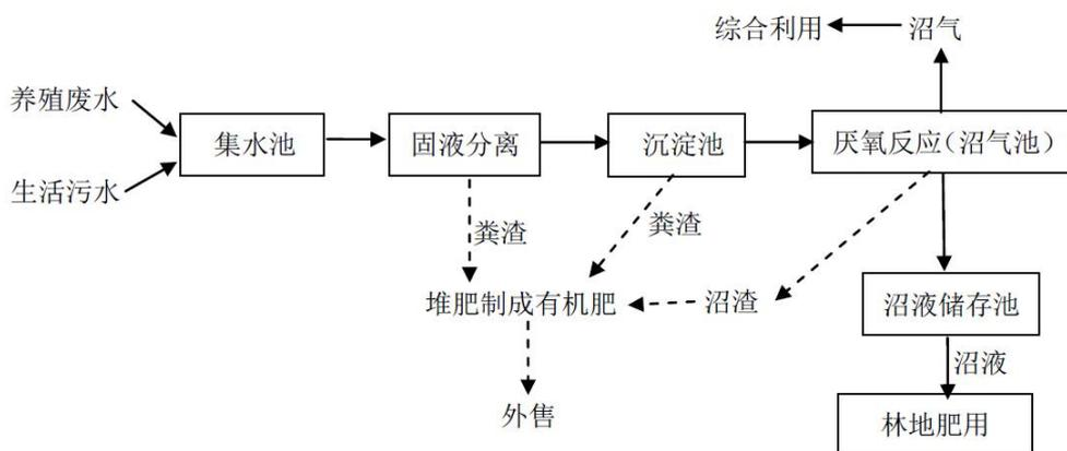
图 7.1-1 污水处理工艺流程图
