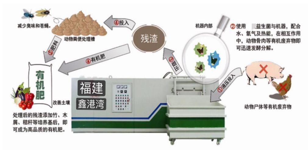
图 3.2-4 病死猪处理工艺流程图
