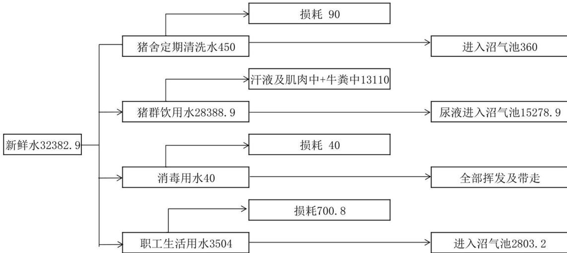
图 3.3-1 本项目水平衡图 (t/a)
